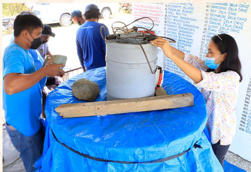
Panangiparabaw iti heater-blower assembly iti garong
